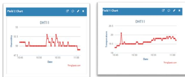
Fig -3 Test Results of DHT11 Sensor
